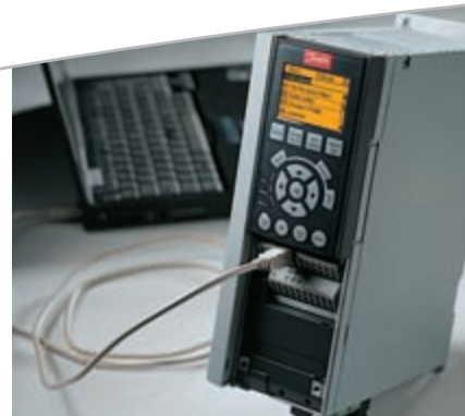
Przetwornicę VLT® AutomationDrive można uruchomić zdalnie i monitorować jej pracę poprzez port USB lub magistralę komunikacyjną. Dostępne jest specjalne oprogramowanie: kreator aplikacji (Wizard), narzędzie do transmisji danych (Data transfer tool), oprogramowanie konfiguracyjne (VLT® Set-up Software MCT 10) oraz narzędzie do zmiany języka interfejsu (Language changer).
