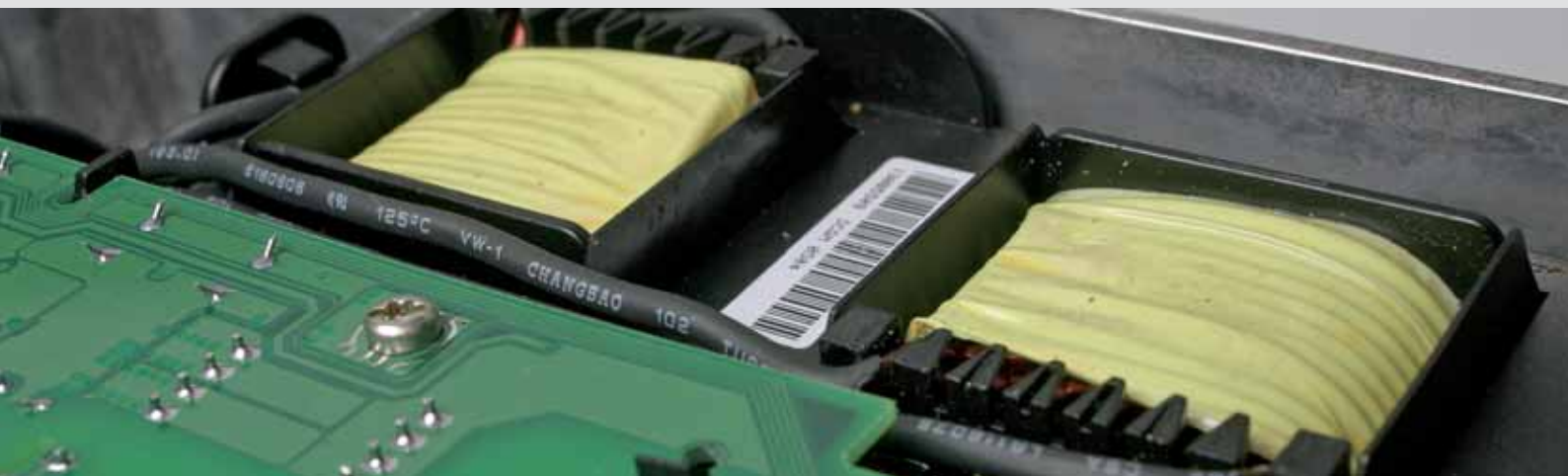
Dławiki DC wbudowane w obwód pośredniczący przetwornicy redukują niskoczęstotliwościowe oddziaływanie napędu na sieć.
